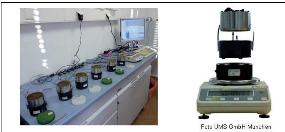
Abb. 1. HYPROP System, links im Multimodus, rechts die Einzelkomponenten des Messsystems.
